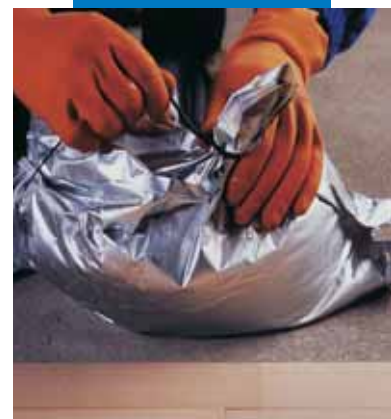
Cierre del envase con una abrazadera adecuada
